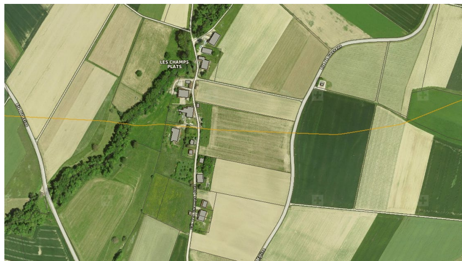
Figure 4 : Localisation du gazoduc (orange). Source : geoportail.vd.ch
